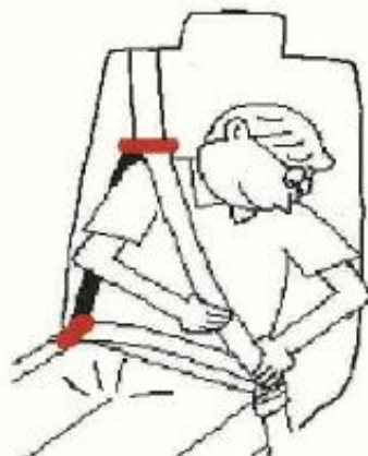
ベルト型幼児用補助装置の一例（使用時のイメージ図）
